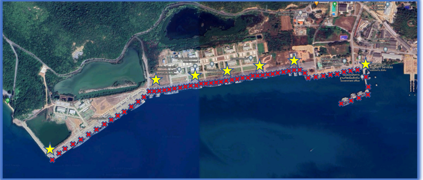
รูปภาพ : ตำแหน่ง หัวจ่ายน้ำ ขนาด 2 ½ นิ้ว จำนวน 54 จุด และ หัวรับน้ำ ขนาด 4 นิ้ว จำนวน 7 จุดของท่าเรือ แหลมเทียน
