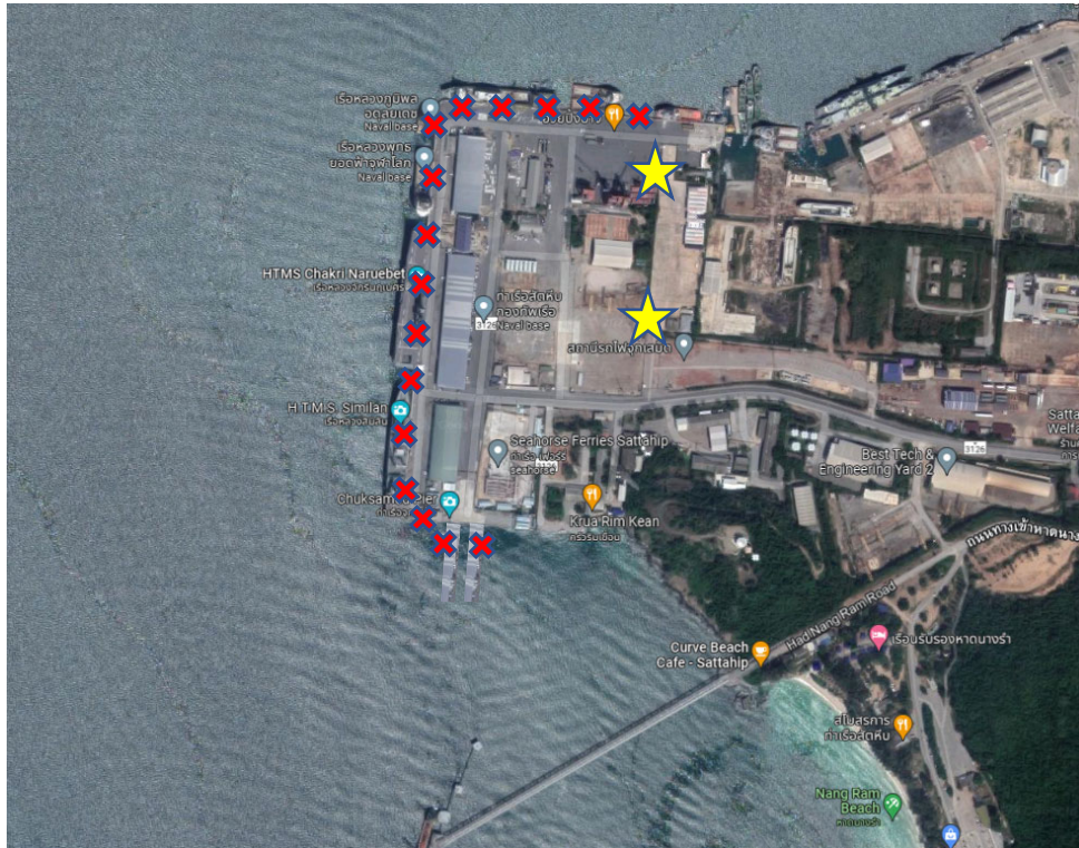
รูปภาพ : หัวดับเพลิงทั้งหมดประมาณ 2 จุด บริเวณ ท่า หมายเลข 5 ประกอบด้วย หัวจ่ายน้ำ ขนาด 2 ½ นิ้ว จำนวน 15 จุด และ หัวรับน้ำ ขนาด 4 นิ้ว จำนวน 2 จุด
